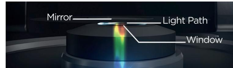
2개의 고정된 anchor point를 통해 흡수된 빛을 분석하는 기술인 True Path Technology™를 적용하여, detection range는 늘리고 오차는 최소화하였습니다. dsDNA 기준 1 - 16,500 ng/ul까지 측정이 가능하며 (NP80 & N60), anchor point가 고정되어 있기 때문에 별도의 calibration 없이도 정확한 계측이 가능합니다. 또한 전원을 켜 후 별도의 lamp warm-up 시간이 필요하지 않으며, 샘플 분석 시간 또한 3.5 - 6초밖에 걸리지 않아 매우 빠르게 농도 측정이 가능합니다.
